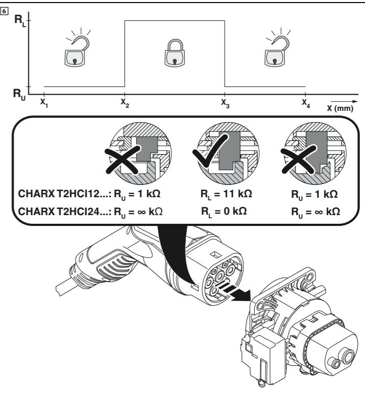
**Зарядная розетка для электромобиля AC типа 2**
